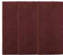
Pode ser usado a seco e lubrificado. Não enferrujam e não contaminam a superfície. Substitui palha, lâ de aço e folhas de lixa grãos finos. Manta não tecida de fibras sintéticas, unidas com resina a prova d'água e impregnada com mineral abrasivo.
