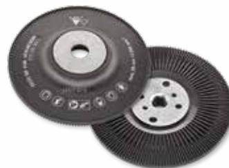
A base de apoio macia M14 Turbo BackingPad II é ideal para trabalho em desbaste e acabamento de metais com discos de fibra. Devido ao seu design exclusivo, ele consegue diminuir a temperatura de trabalho, melhorando em 10% o desempenho, o acabamento e o tempo de desbaste.
